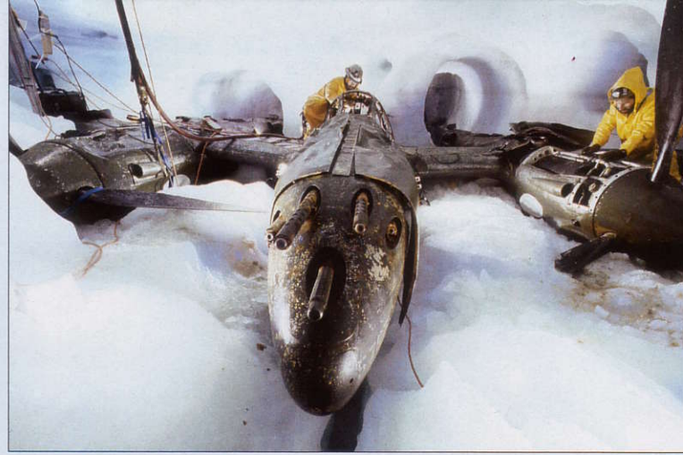
In einer ins Eis geschmolzenen Höhle wurde diese „Lightning“ 1992 von den Helfern für die Bergung durch den schmalen Schacht teilweise demontiert.
